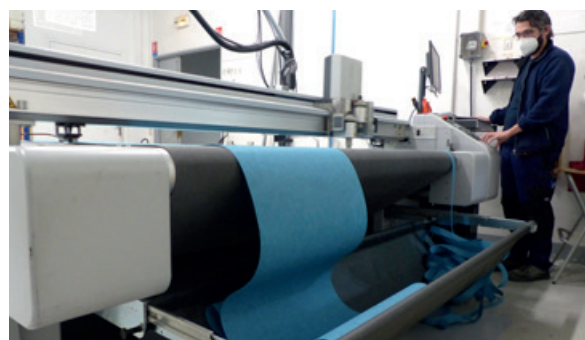
Dans l'atelier de découpe, Pierre débite des bandes de non-tissé destinées au façonnage des tubes (confié à des ateliers de réinsertion) utilisés pour fabriquer des cloisons de production française et des pièces des faux-plafonds Drop Stripe. Les cloisons sont réalisées en tubes collés issus de rouleaux de 40 et 60 cm.
