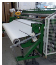
Les machines anciennes ou fabriquées sur mesures pour découper des rouleaux de plus petite largeur dans les jumbos de 250 ml côtoient les équipements numériques de la dernière génération. Les cylindres des berceaux de réception sont revêtus d'un matériau conçu pour permettre au papier d'y adhérer et d'être entraîné.
