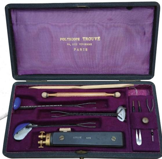
Le polyscope et ses accessoires d'éclairage dans son coffret, modèle produit postérieurement à 1878 par l'atelier de Trouvé (ivoire, ébène, laiton doré, émail sur cuivre). Les bâtonnets sont destinés à la manipulation des très fins filaments de platine au milieu desquels on peut apercevoir une mini-lentille qui, par incandescence, produit une forte lumière protégée par les petites paraboles réflectrices.
