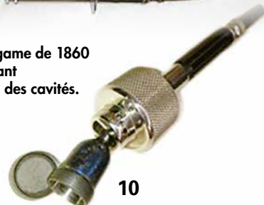
10. Amalgamateur à mécanique excentrique pour tour de cabinet, ca 1930. Il s'agit de l'un des premiers systèmes mécanisés pour remplacer les mortiers.
