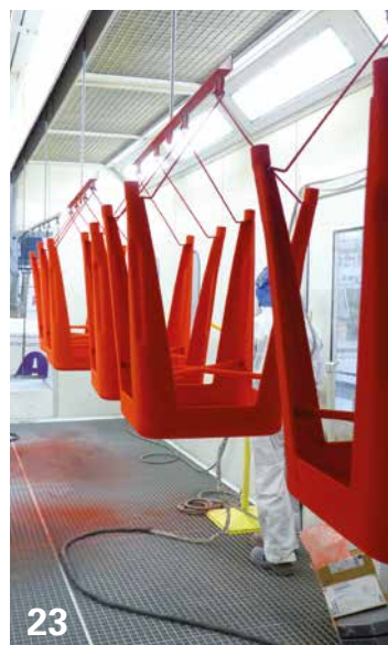
21. Chaîne de peinture. 22. Un flux d'air balaie la cabine de poudrage de haut en bas pendant que deux hommes appliquent la poudre d'une gestuelle précise et experte. La peinture employée est de qualité, sans plomb ni TGIC (Akza, IGP, Axalta). 23. Sortie des pièces avant la cuisson.
