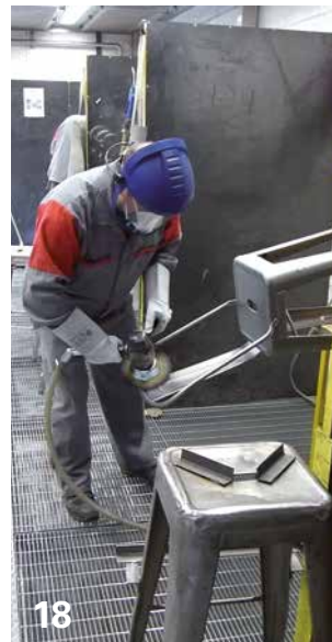
18. Brossage 19 et 20. Les soudeurs qualifiés sont tous polyvalents. Ici, brasage des croisillons.
