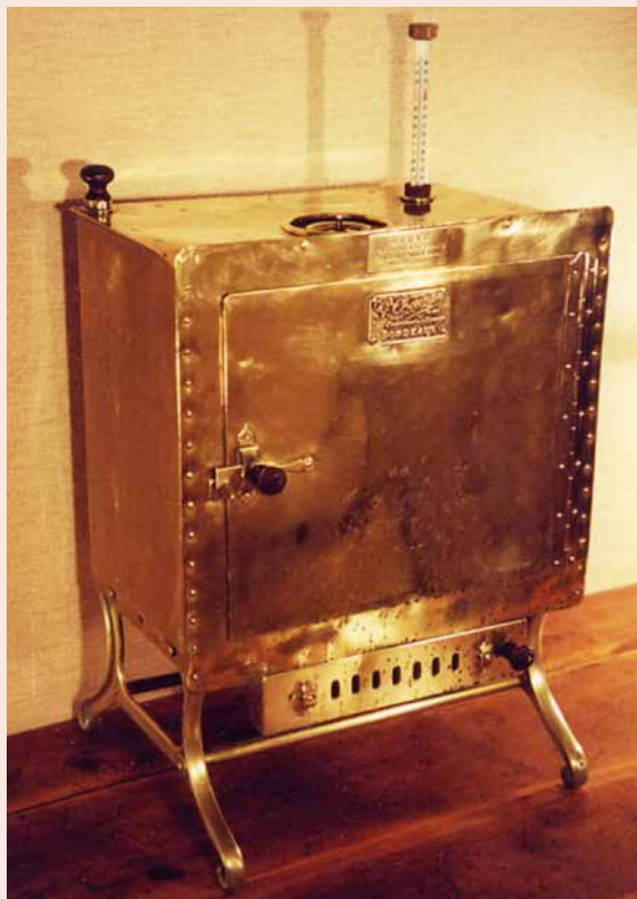
Ci-contre, stérilisateur à air chaud, système Soulard, par G. Creuzan, à Bordeaux (1900). Chauffage à alcool ou au gaz, avec son thermomètre de précision.
