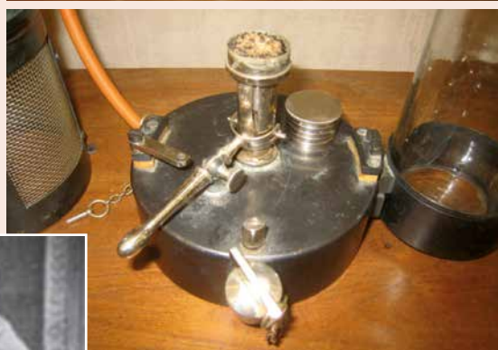
En haut, pulvérisateur de Lucas-Championnière par Collin à Paris, avec son brûleur à alcool, ses deux becs de vaporisation, son récipient à phénol.
