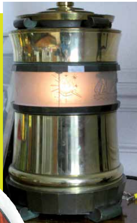
Une étonnante lampe radio. Pour changer de fréquence il faut tourner son socle.
