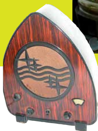
Recherché par beaucoup de collectionneurs le 930 A de Philips est plus connu sous le nom de « Boîte à Jambon ». Ce « 4 lampes » a une carrosserie en Arbolite, sorte de bakélite inventée par Philips.
