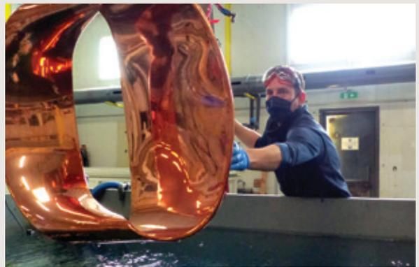
Florian, responsable de l'électroformage, dépose une chaise en cuve de rinçage après la sortie du bain cuivreux. La finition manuelle est réalisée dans l'atelier SMD de préparation, de finition et de contrôle visuel pour les pièces décoratives. À ce stade, les allers retours entre la salle des cuves et ces postes sont fréquents. Le vernis est appliqué en cabine.
