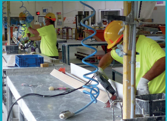
Sur un long établi Gilbert C., David G. et Fred L. assemblent les différentes découpes de plaque de plâtre pour donner forme à une corniche.
