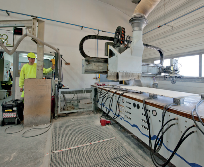
Le bras articulé de cette machine (Homag) sélectionne les outils avec précision.
