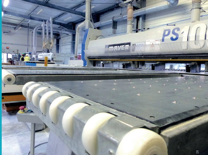
Machine à commande numérique qui permet de réaliser des découpes droites. Soulevées à l'aide d'un chariot, les plaques sont déposées sur un convoyeur, l'opérateur saisit alors les données diverses et la programmation des outils qui seront utilisés.
