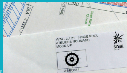
Une enveloppe référencée contenant des étiquettes pour le numérotage des pièces suit le parcours des éléments de la phase de conception jusqu'à la pose. La digitalisation permet de retrouver toutes ces informations sur un site internet dédié.
