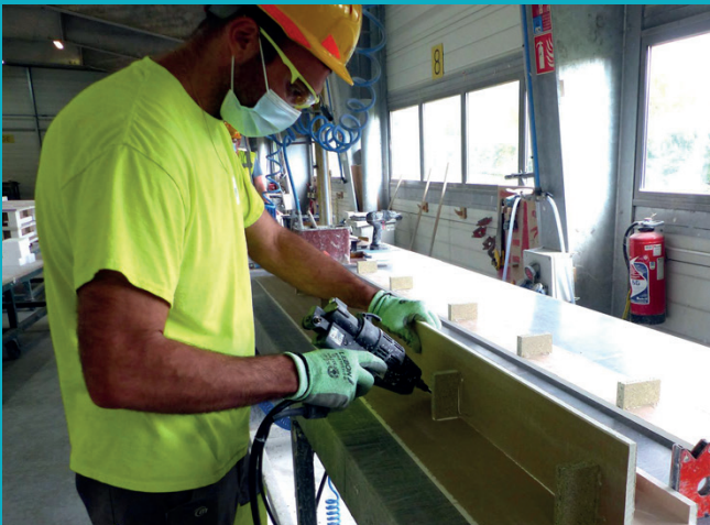
Sur un long établi Gilbert C., David G. et Fred L. assemblent les différentes découpes de plaque de plâtre pour donner forme à une corniche.
