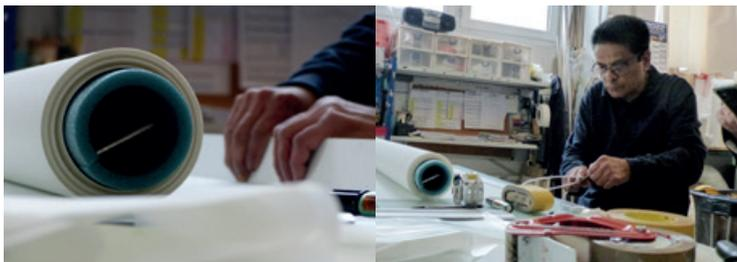
Kasippillai colle une barre de tension en bout de bande avec un scotch extrêmement résistant. Il l'insère et la dissimule en l'enroulant dans le papier, puis la perfore pour y installer les élastiques qui permettront de tirer et fixer la bande de plafond. Ce système est breveté.
