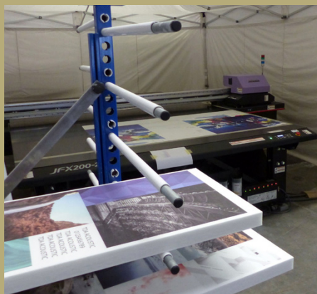
Imprimante à plat grand format et impression sur dalle de faux plafond en métal perforé
