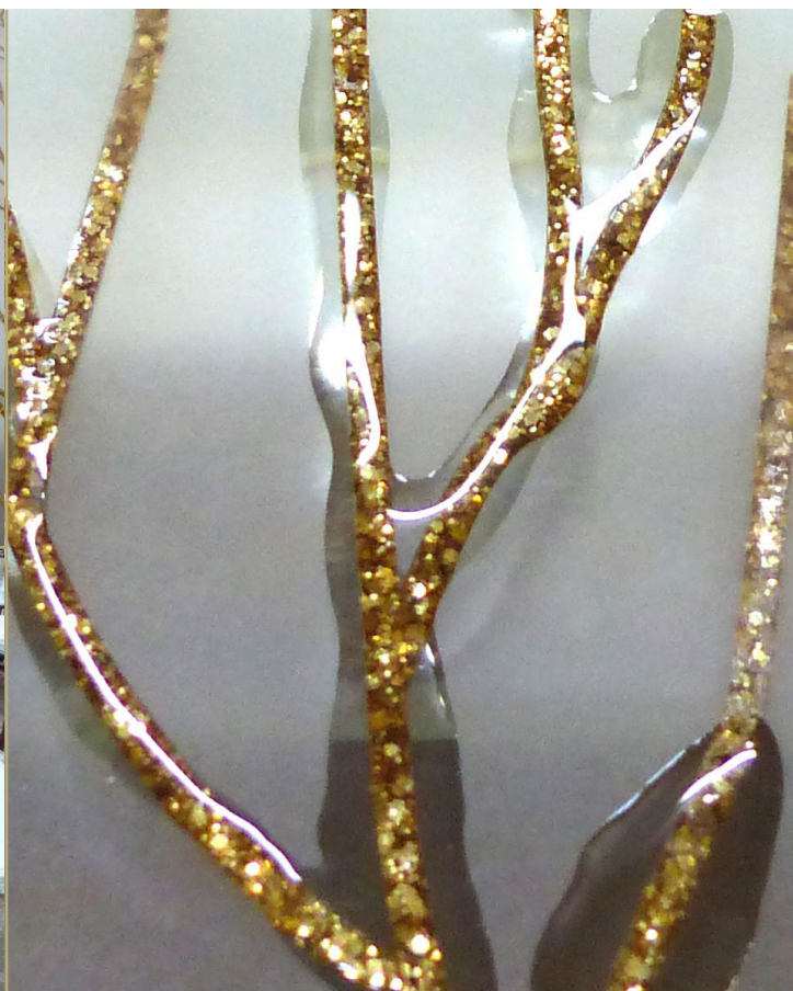
Plaque et détails d'un modèle dont les gravures numériques sont métallisées, puis remplies de résine avant d'être polies et coulées.
