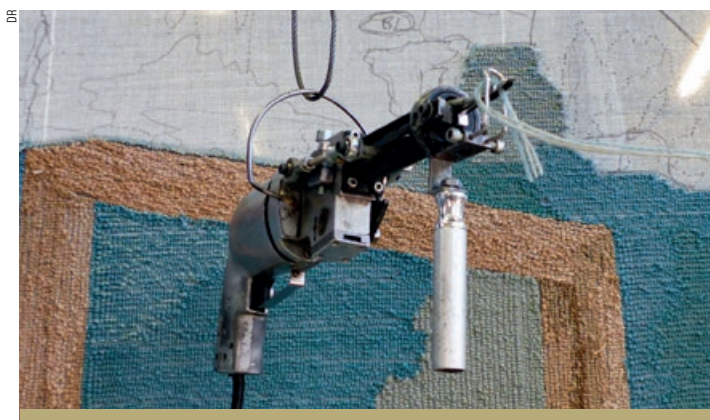
Fabienne tufte sur l'envers une œuvre de Constanza Valesse pour les États-Unis. Elle contrôle en permanence le résultat sur l'avant de l'ouvrage en se référant aux pochettes de production et de finition, aux impressions des maquettes sur papier et aux images numériques recto et verso de l'œuvre.
