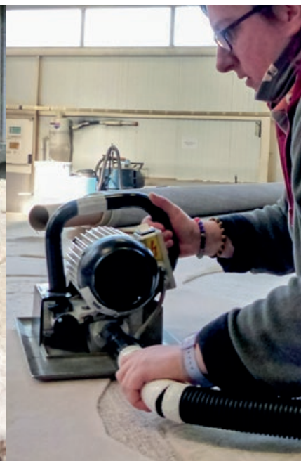
Après séchage, les ouvrages sont déposés des cadres et des métiers pour être ourlés, peignés et rasés régulièrement. Les surfaces sont finies par épilage et ciselage. Le ciselage est effectué horizontalement, verticalement ou en biseau suivant les dessins. Caroline effectue de multiples passages de tondeuse pour assurer une parfaite régularité de hauteur et de satiné des fils qui constituent le velours.
