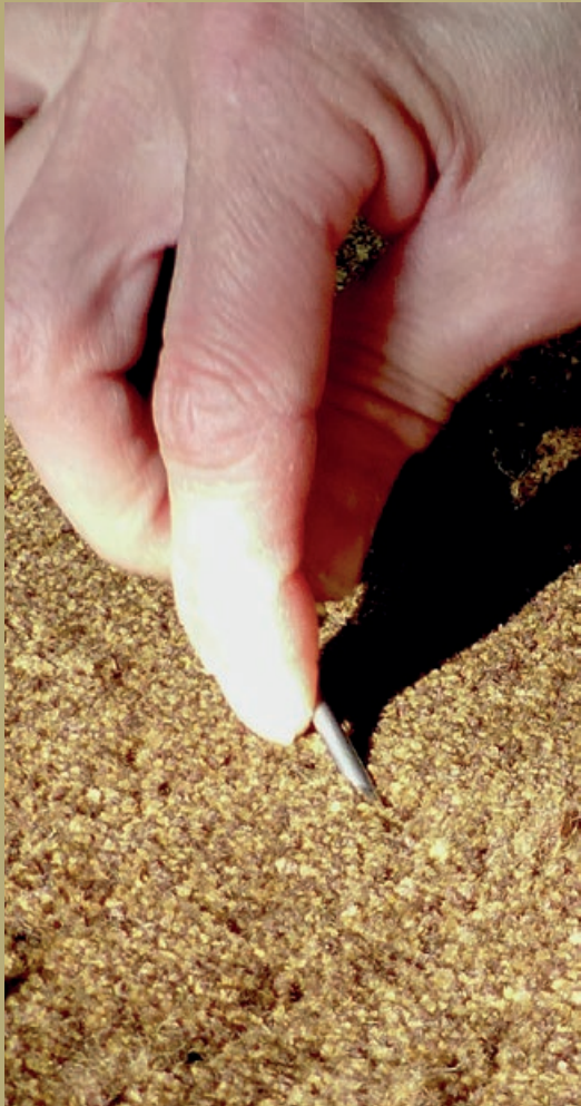
Sefika ôte des bouclettes à l'aide d'un poinçon. La confection des ourlets de toile retournée et la pose de galons sont effectuées dans l'atelier de finitions. Mathilde colle un galon plat sous les bordures de ce chemin d'escalier.
