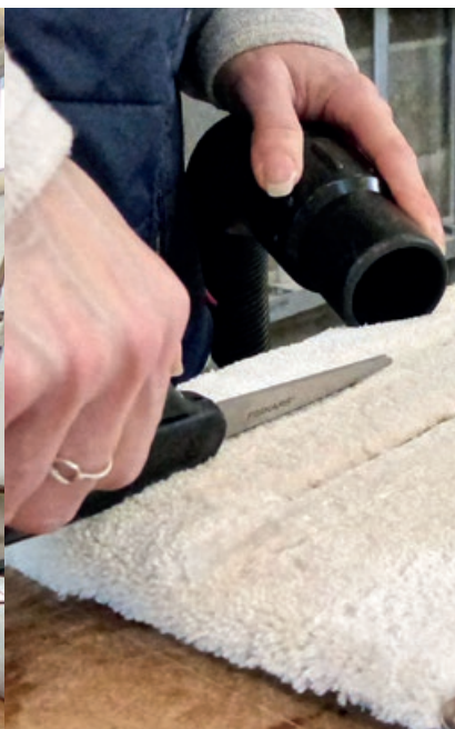
Après séchage, les ouvrages sont déposés des cadres et des métiers pour être ourlés, peignés et rasés régulièrement. Les surfaces sont finies par épilage et ciselage. Le ciselage est effectué horizontalement, verticalement ou en biseau suivant les dessins. Caroline effectue de multiples passages de tondeuse pour assurer une parfaite régularité de hauteur et de satiné des fils qui constituent le velours.
