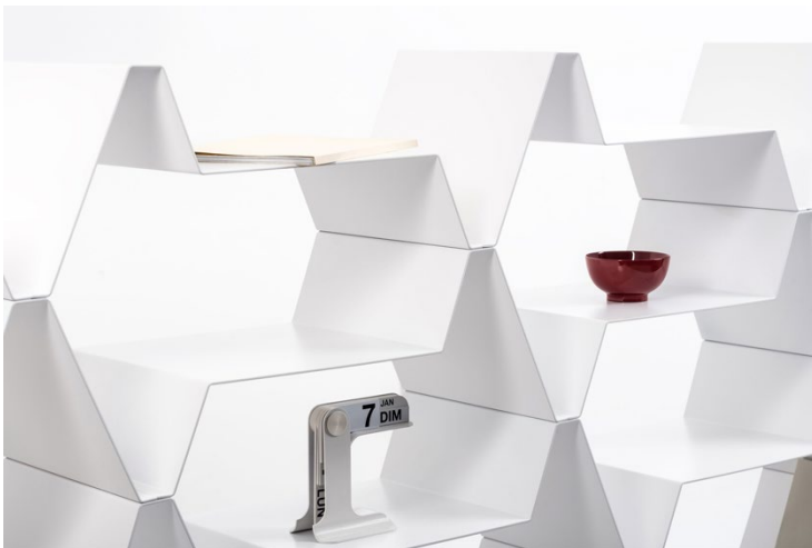
Identité formelle unique et principe constructif sobre et radical caractérisent cette belle étagère et ses déclinaisons en éléments hauts, bas, bibliothèque, séparateur... La conception à partir de tôle en aluminium découpée et pliée, permet de réduire considérablement la perte de matière. Le thermolaquage mat est disponible en blanc, rose pâle, bleu pigeon, vert bouteille, gris anthracite. Fréquence , design Jean Couvreur, édition Kataba
