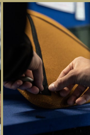
Méthode d'enfilage à la main et pose de la languette d'une fermeture éclair.
