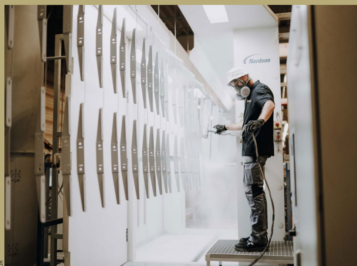
Station manuelle de peinture en époxy.
