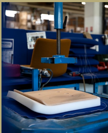
Collage et rembourrage font partie des étapes de fabrication d'une assise.
