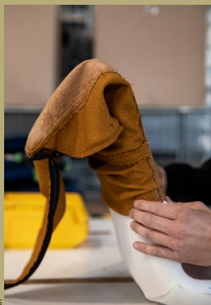
Méthode d'enfilage à la main et pose de la languette d'une fermeture éclair.
