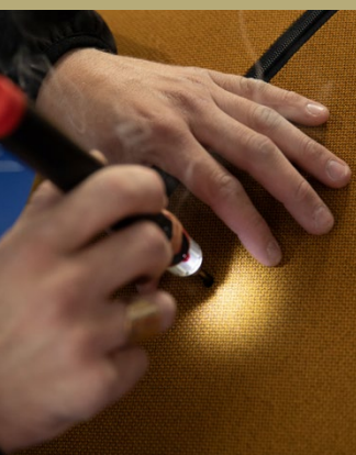
Pré-perçage de trous au fer à souder pour l'assemblage des pieds.
