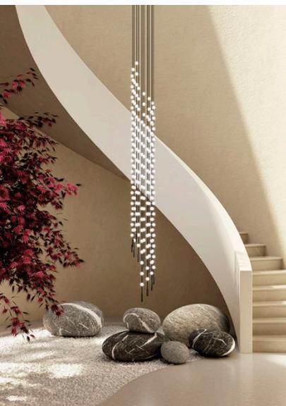
**Multidot** est une réinterprétation des chandeliers anciens en système de technologie moderne flexible et polyvalent, permettant la création d'une infinité de compositions. Chaque câble basse tension est un élément structurel et décoratif qui peut être installé librement dans l'espace en différentes quantités et longueurs, et associé à la quantité voulue de sphères lumineuses à LED.
