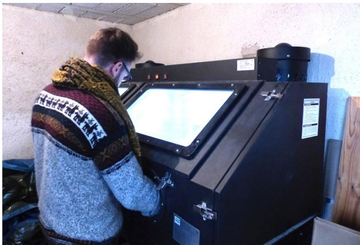
Cette sableuse permet de parfaire la finition de la face arrière de *Fluence* (la collection *Orogenèse* est finie par polissage, sans sablage).
