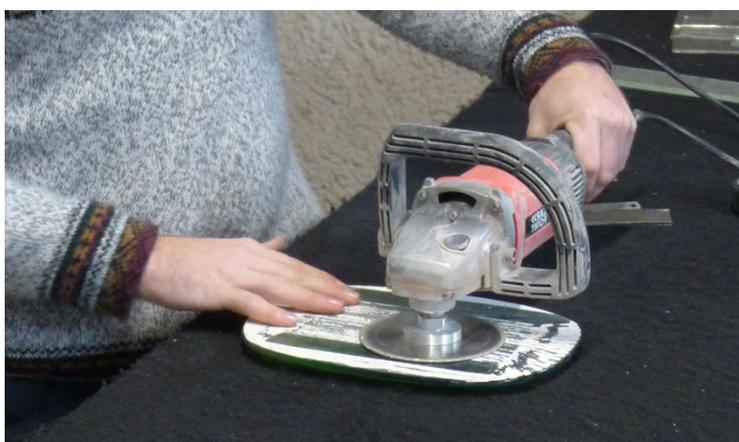
Nettoyage par ponçage et lustrage des dépôts de pierre réfractaire collés au dos de la pièce (le ponçage est effectué avec des outils au diamant).
