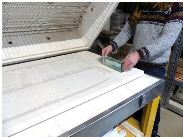
En respectant l'ordre de leur organisation à plat et en prenant soin de ne pas modifier le dépôt d'émail dégradé, il dispose les lames en pile sur la sole du four.
