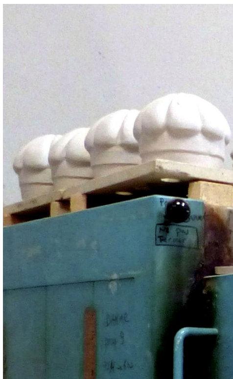
Cabochons de façade du catalogue Céramiques du Beaujolais en attente démaillage.
